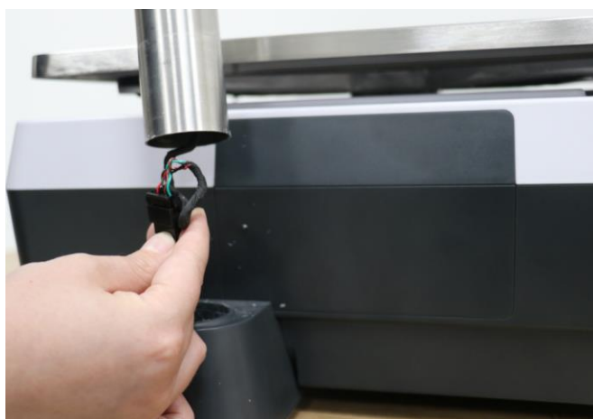
③ Ta kabelkontaktarna in i pelaren
