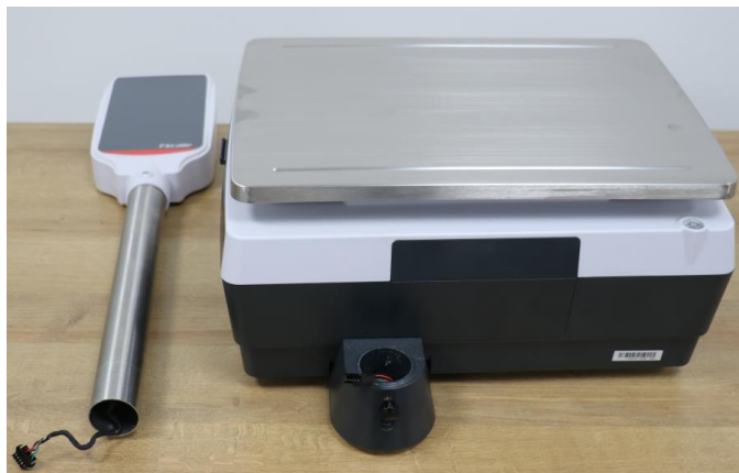
① Ta ut pelardisplay-hopsättningen
