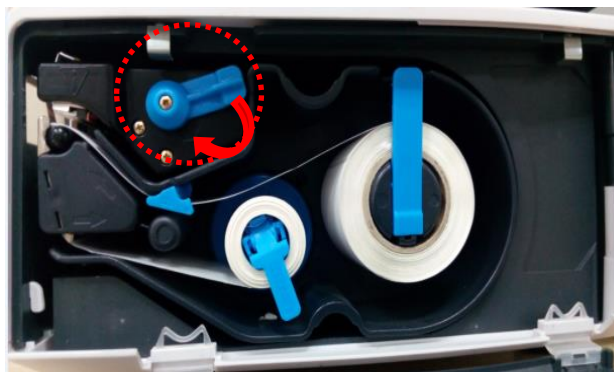
⑥ Sätt i kassetten och vänd spakarna för att stänga läget
