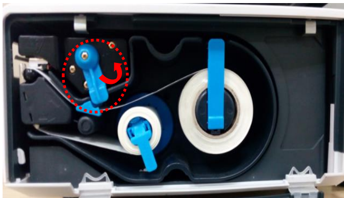
② Vrid spaken till öppet läge
