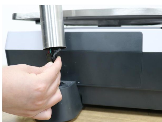
④ Sätt in pelaren med kabeln till hållaren
