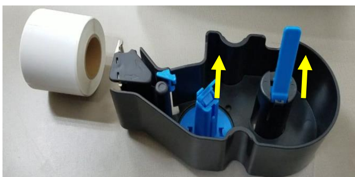
④ Lossa stoppspakarna och ta sedan bort pappersrullen och etikettkärnan
